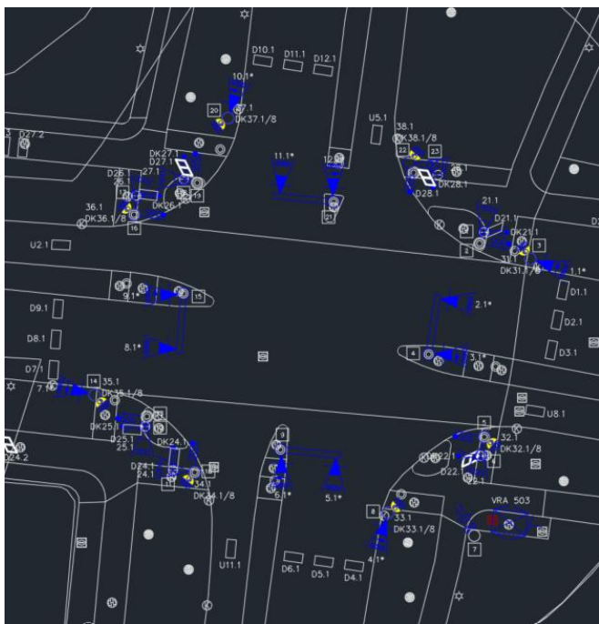
Figuur 2, voorbeeld van een tekening waarbij de markering ontbreekt.
